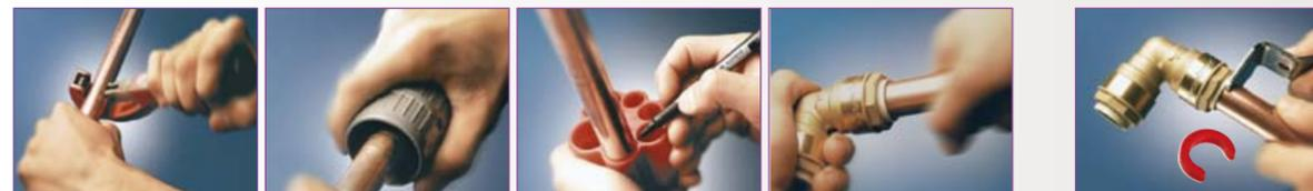
1. Отрежьте трубу роторным резаком.
