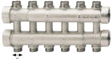
Двойной распределительный коллектор с выходами НР, для использования с медными, РЕХ, полибутиленовыми или металлопластиковыми трубопроводами. Корпус из ковнанной никелированной латуни. Максимальная рабочая температура: 110°C. Резьбы: ISO228 (эквивалентно DIN EN ISO 228 и BS EN ISO 228). Наружная резьба 'G' с коническим посадочным местом, внутренний диаметр 16мм. межцентровое расстояние 38мм.
